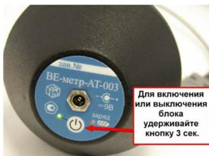
5.2.2. Нажатием на кнопку «Вкл» включить блок измерений и ин-
