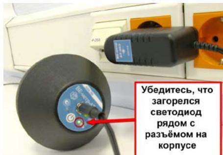
**ВНИМАНИЕ!** В случае длительного перерыва в эксплуатации Измерителя следует производить заряд аккумуляторных батарей антенного блока и блока измерений и индикации не реже чем 1 раз в месяц.
