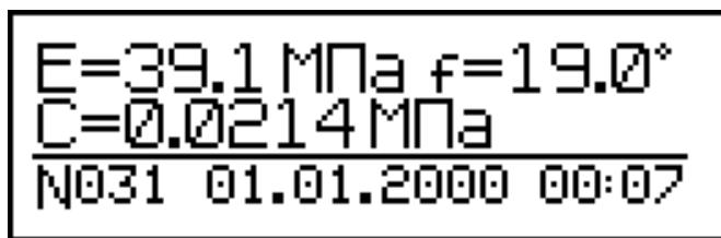
**ВНИМАНИЕ!** При работе в режиме «К», в случае перемещения на участок испытаний с новыми параметрами грунта обязательно проверить соответствие  $P_{max}$ .
