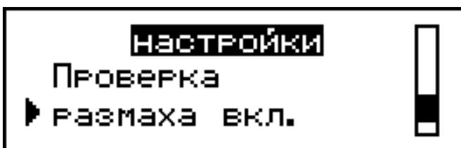
Включить либо отключить проверку размаха показаний пенетрометра. Если проверка размаха включена при обнаружении большого размаха показаний, на дисплее появляется сообщение:
