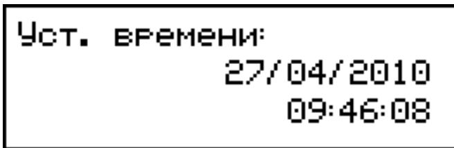
Каждая позиция активируется последовательно после нажатия клавиши **ВВОД**, коррекция клавишами «↑, ↓». Для выхода из режима нажать клавишу **РЕЖИМ**.
