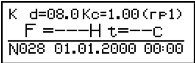
**Примечание** – Повторная автоподстройка возможна в любой момент времени по желанию пользователя, в любом режиме при нажатии клавиши « $\uparrow$ » в течение трех секунд.
