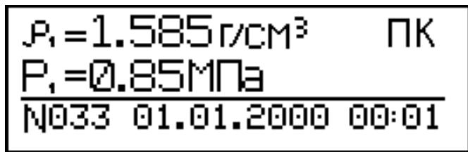
Используя клавиши «↑, ↓» выбрать точку для ввода или редактирования данных. Нажать клавишу **ВВОД**, далее используя клавиши «↑, ↓» и **ВВОД** поразрядно ввести числовые значения плотности песчаного грунта ( $\rho$ ) и соответствующее этой плотности сопротивление пенетрации (Р). Для выхода из режима нажать клавишу **РЕЖИМ**.
