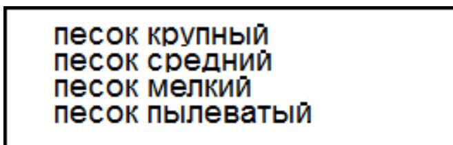
Выбрать вид песчаного грунта используя клавиши «↑, ↓» и нажать ВВОД, дисплей принимает вид, например:
