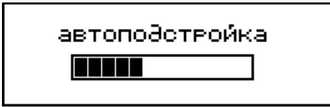
Повторный звуковой сигнал свидетельствует об окончании автоподстройки и переход в режим «Измерение», дисплей принимает вид:
