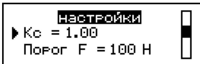
Возможна корректировка модуля упругости грунта (Е) по результатам измерений прибором ударно динамического нагружения (ПДУ-МГ4 «Удар»), Коэффициент совпадения (Кс) вычисляется по формуле:
