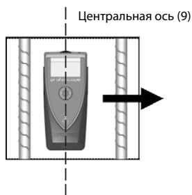
Рисунок 12: Перпендикулярное движение и отображение близости стержня
