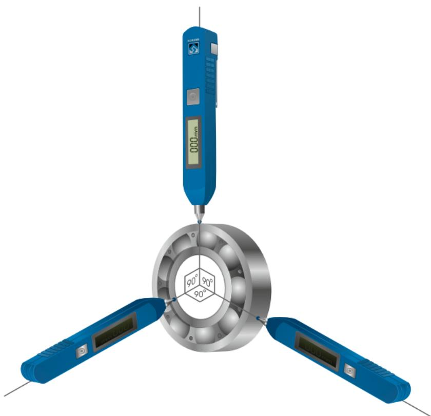
Рис. 3-2. Рекомендуемые точки измерения вибрации.
