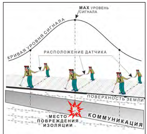
применение датчика-определителя дефектов коммуникации (ДОДК) методом max
