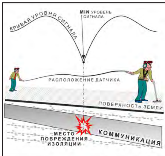
применение датчика-определителя дефектов коммуникации (ДОДК) методом min
