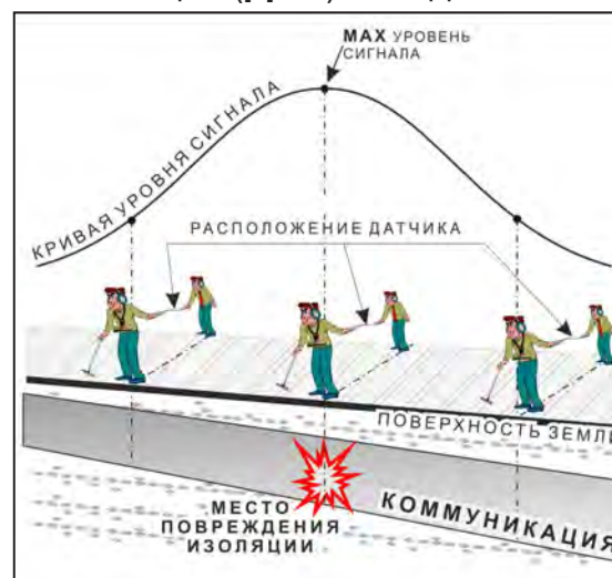
применение датчика-определителя дефектов коммуникации (ДОДК) методом max
