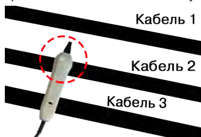
Выбор кабеля по максимальному сигналу
