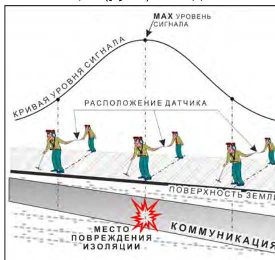
применение датчика-определителя дефектов коммуникации (ДОДК) методом max
