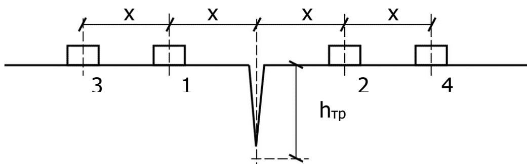
Сначала датчики устанавливаются на точки 1-2 схемы (трещина находится посередине, т.е.  $l=2x$ ) и измеряется время  $t_1$ , затем датчики устанавливаются на точки 3-4 (трещина - посередине  $l=4x$ ), измеряется время  $t_2$  и автоматически вычисляется глубина трещины по формуле (2):
