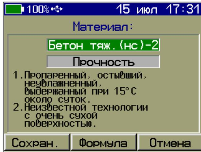
Формула, по которой будет производиться пересчет скорости ультразвука в значение прочности, доступна по нажатию программной кнопки «**Формула**».
