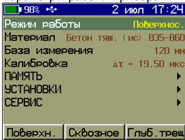
В верхней части дисплея прибора во всех режимах работы выводится строка статуса, в которой отображается состояние заряда встроенного аккумулятора, подключение к USB-порту компьютера или к внешнему источнику питания, текущее время.
