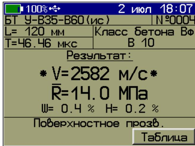
При нарушении акустического контакта (в установленном диапазоне измерения времени) для всех измеряемых параметров индицируются знаки «?», а при его отсутствии знаки «?» индицируются и для скорости  $V$ .
