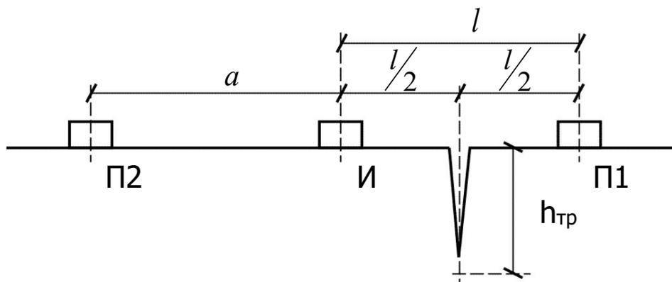
Сначала датчики устанавливаются на точки И-П1 (трещина находится ровно посередине) и измеряется время  $t_1$ , затем датчики устанавливаются на точки И-П2, измеряется время  $t_a$  и автоматически вычисляется глубина трещины по формуле (1):
