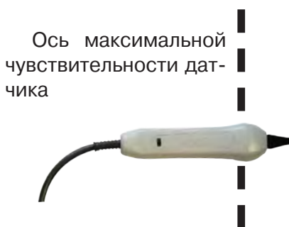
Выбор кабеля по максимальному сигналу
