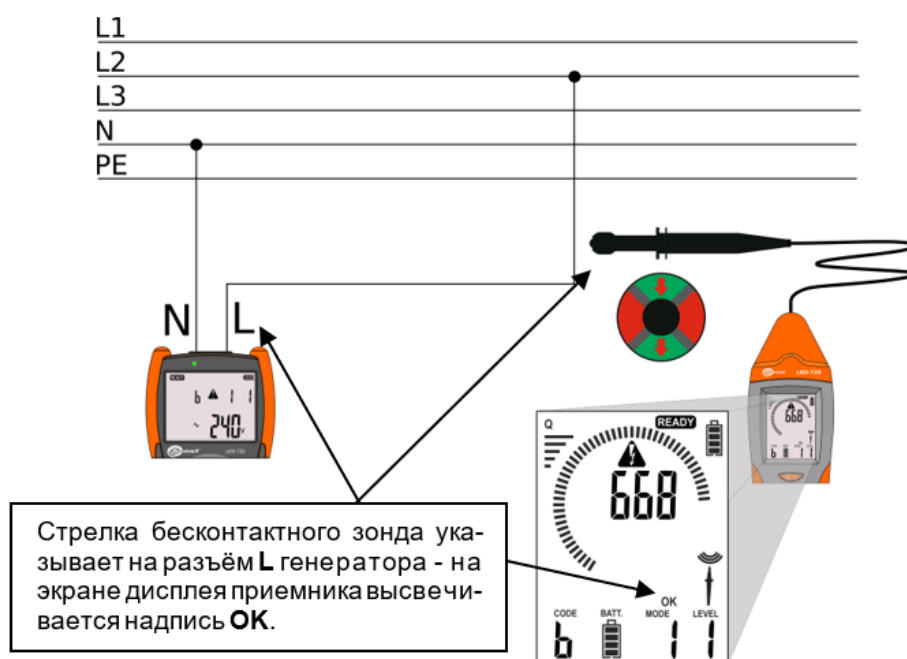
Идентификация разъёма L генератора
