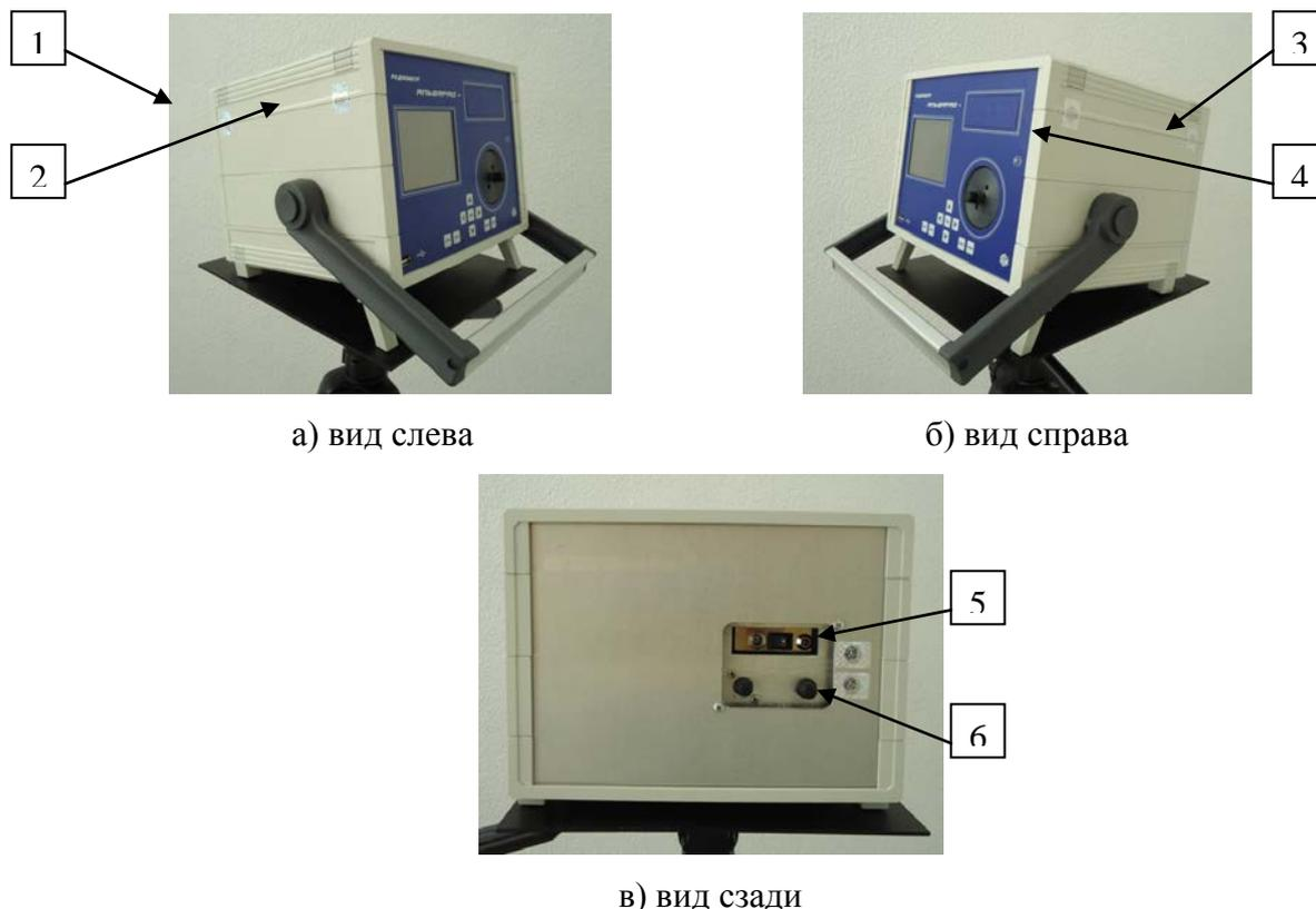
Рисунок 2 Схема размещения специальных пломб (1, 2, 3, 4, 5, 6 – места размещения пломб)
