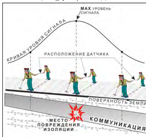
применение датчика-определителя дефектов коммуникации (ДОДК) методом max
