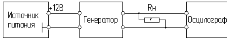
Рис. 10. Схема проверки выходной мощности и параметров сигнала генератора
