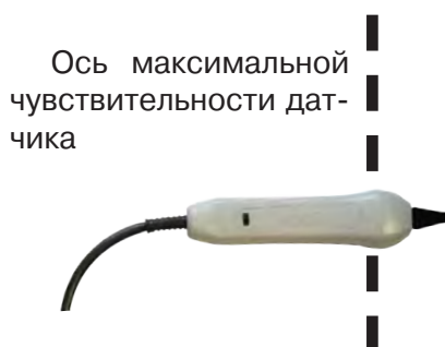
Выбор кабеля по максимальному сигналу
