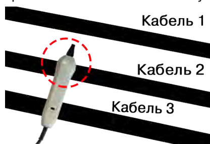
Выбор кабеля по максимальному сигналу
