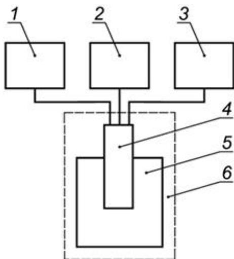
1 - блок питания СИ; 2 - вольтметр цифровой универсальный; 3 - вторичное устройство для контроля цифрового выходного сигнала (при необходимости); 4 - СИ; 5 - источник ГС (статический генератор); 6 - камера климатическая (только при проведении операций поверки по 9.4.2 или 9.4.3)
