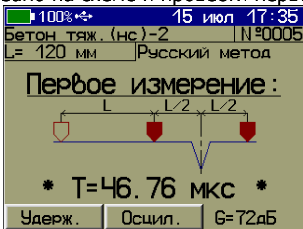
«Русский метод» измерения глубины трещины
