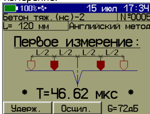
«Английский метод» измерения глубины трещины
