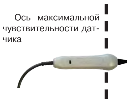
Выбор кабеля по максимальному сигналу
