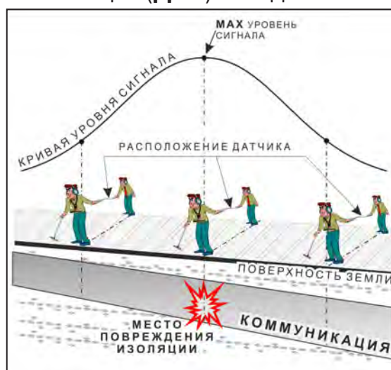
применение датчика-определителя дефектов коммуникации (ДОДК) методом max
