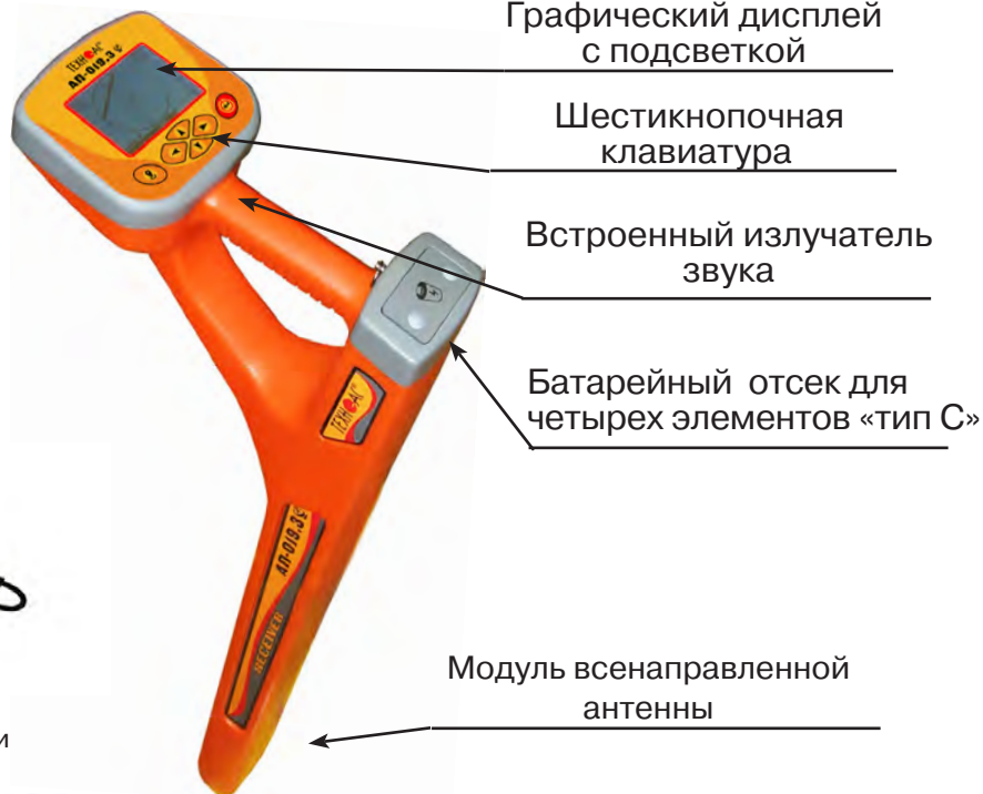
ДОДК-117 Датчик-определитель дефектов коммуникации
