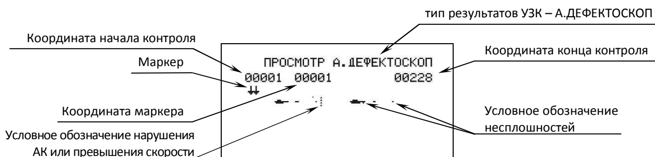
Рисунок 39 - Просмотр результатов УЗК - А.ДЕФЕКТОСКОП
