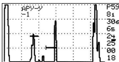
Рисунок 89 - Контроль с применением АРУ.
