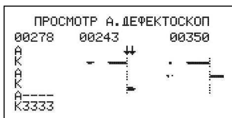
Рисунок 41 - Просмотр результатов УЗК с расшифровкой для толщин 10 мм и более.
