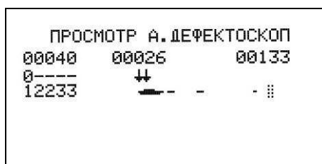
Рисунок 40 - Просмотр результатов УЗК с расшифровкой для толщин 4÷9 мм.
