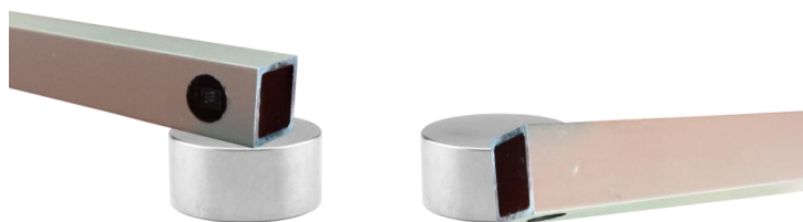
Рисунок 2.6 – Измерение тангенциальной составляющей вектора индукции магнитного поля на торцевой и боковой поверхности изделия
