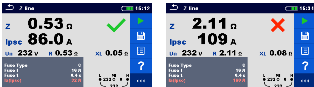
Рисунок 7.40: Примеры результатов измерения полного сопротивления линии.
