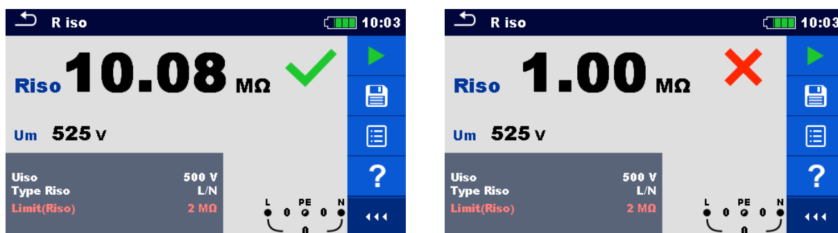
Рисунок 7.9: Примеры результатов измерения сопротивления изоляции.
