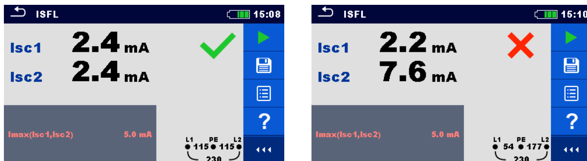
Рисунок 7.70: Примеры результатов измерения тока утечки первичного повреждения.
