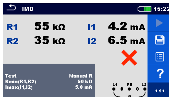
Рисунок 7.73: Пример результатов испытания IMD (устройства контроля изоляции).
