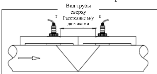
V-ОБРАЗНЫЙ СПОСОБ КРЕПЛЕНИЯ ДАТЧИКА
