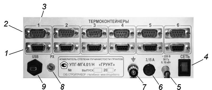
б) задняя панель блока управления
