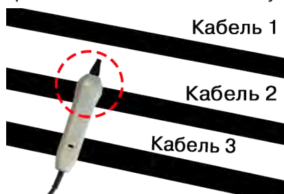
Выбор кабеля по максимальному сигналу
