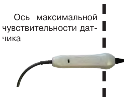
Выбор кабеля по максимальному сигналу
