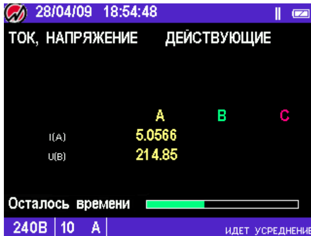
Рисунок 4.2.11 Режим отображения усредненных значений
