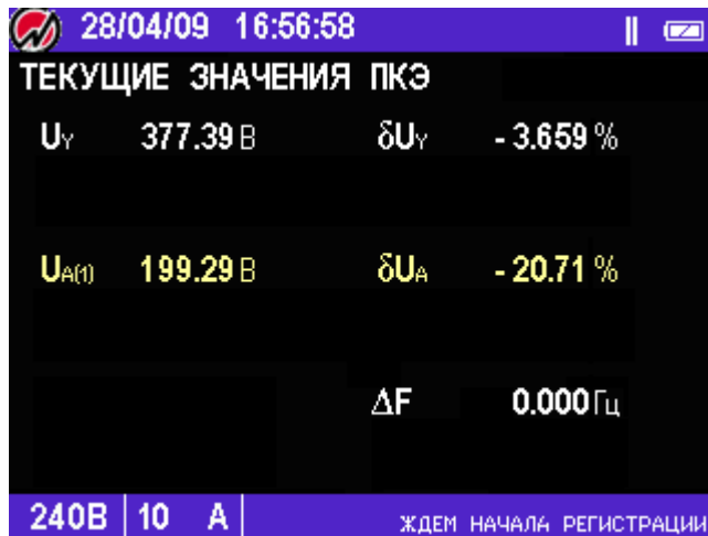
Рисунок 4.3.6 Окно отображения установившегося отклонения напряжения, коэффициентов несимметрии напряжения и отклонения частоты для различных схем включения
