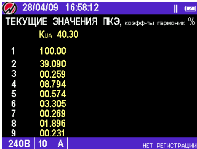
Рисунок 4.3.8 Окна отображения коэффициентов искажения синусоидальности и гармонических составляющих напряжений и токов для различных схем включения
