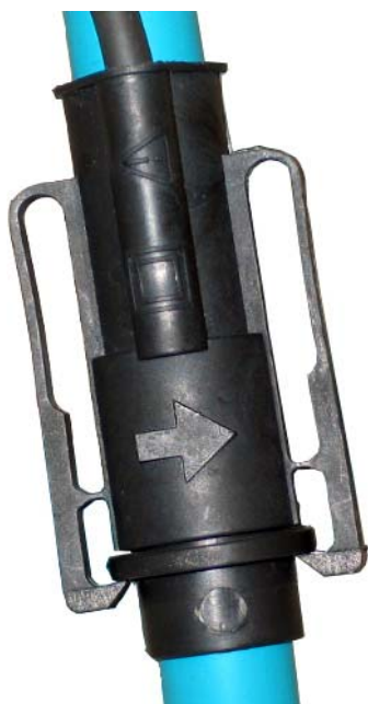
Рисунок А11 Расположение маркировки 'генератор → нагрузка' на токоизмерительных клещах 3000А/300А.
