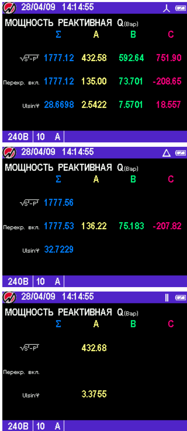
Рисунок 4.2.4 Режим отображения реактивной мощности для различных схем включения
