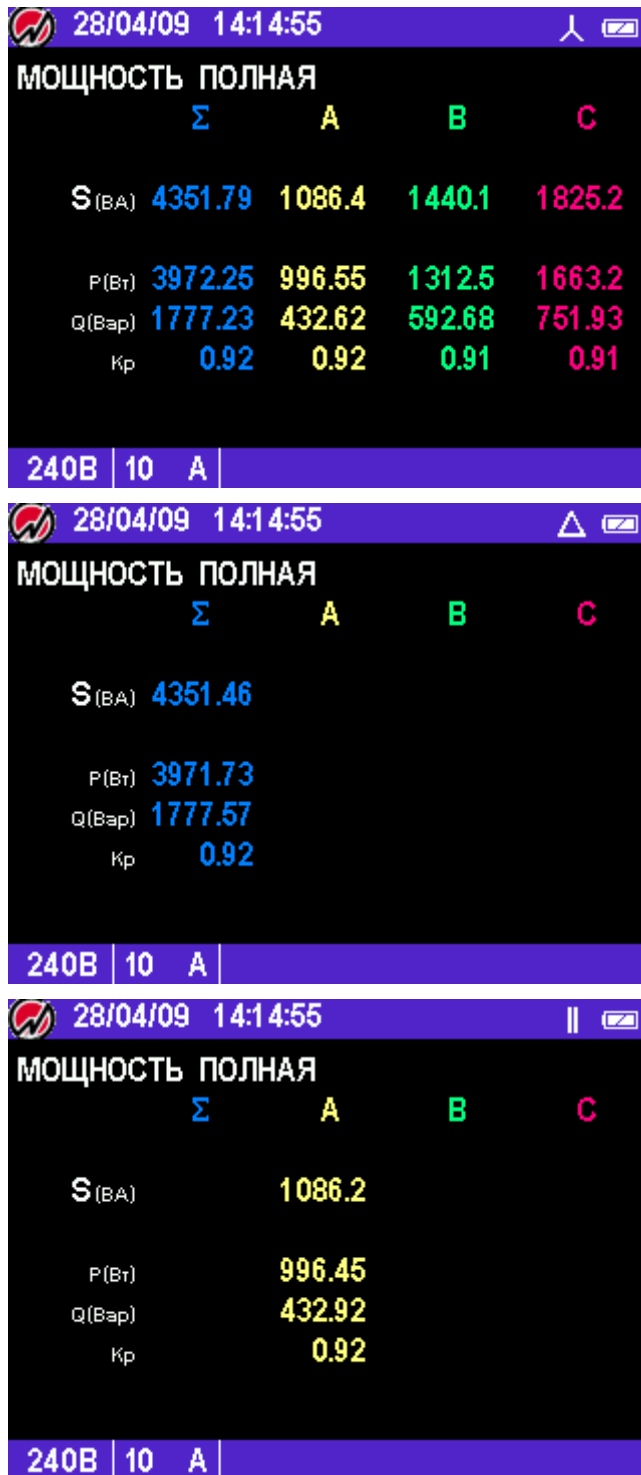
Рисунок 4.2.5 Режим отображения полной мощности для различных схем включения
