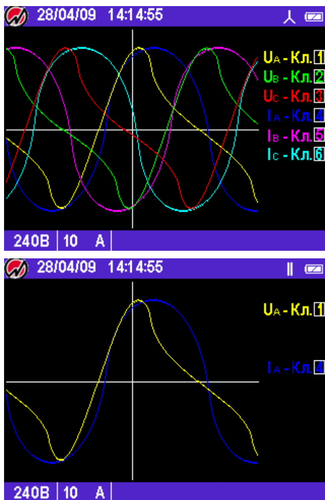
Рисунок 4.2.9 Режим отображения формы сигнала
