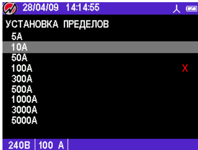
Рисунок 4.4.3 Меню выбора пределов измерения Энерготестера ПКЭ
