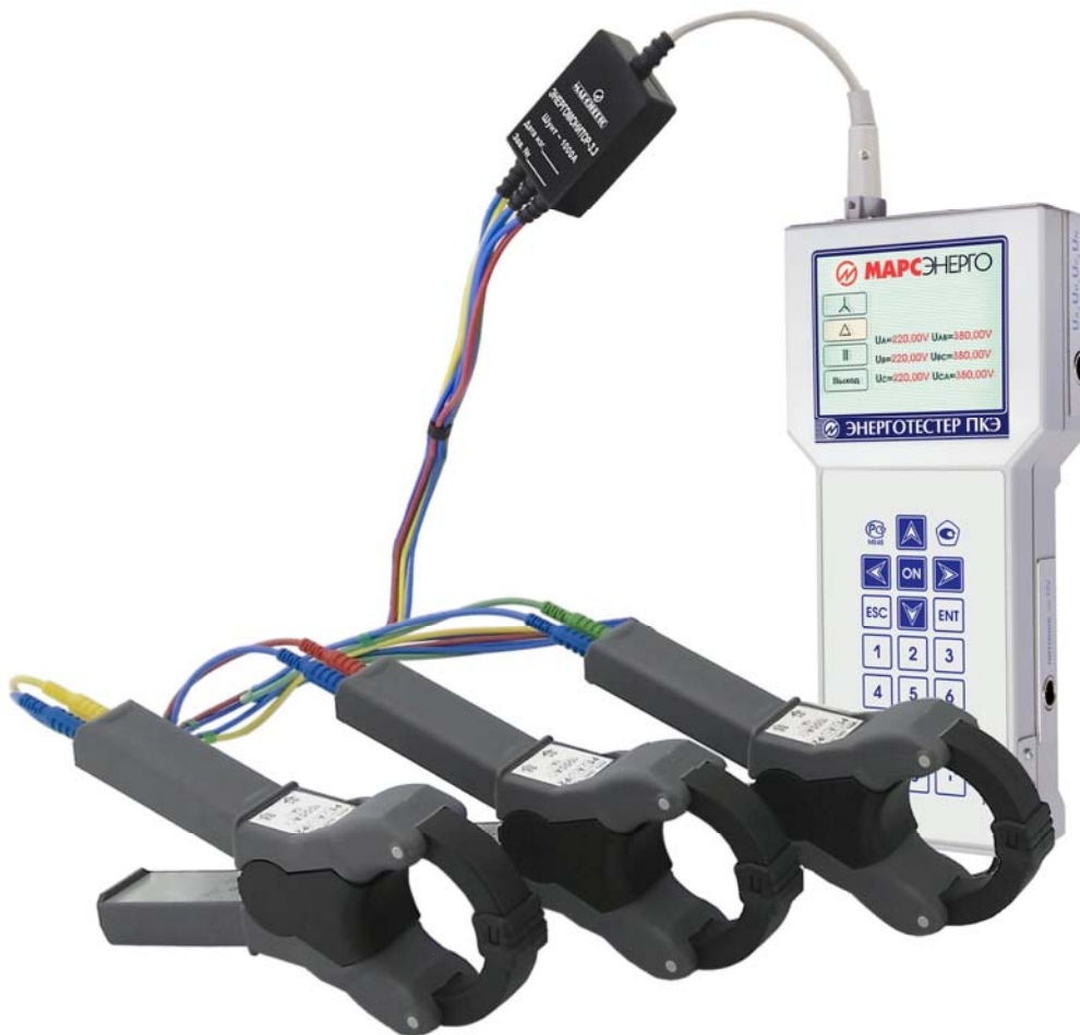
Рисунок А7 Схемы подключения токоизмерительных клещей 1000А к Энерготестеру ПКЭ через Шунт 1000А.
