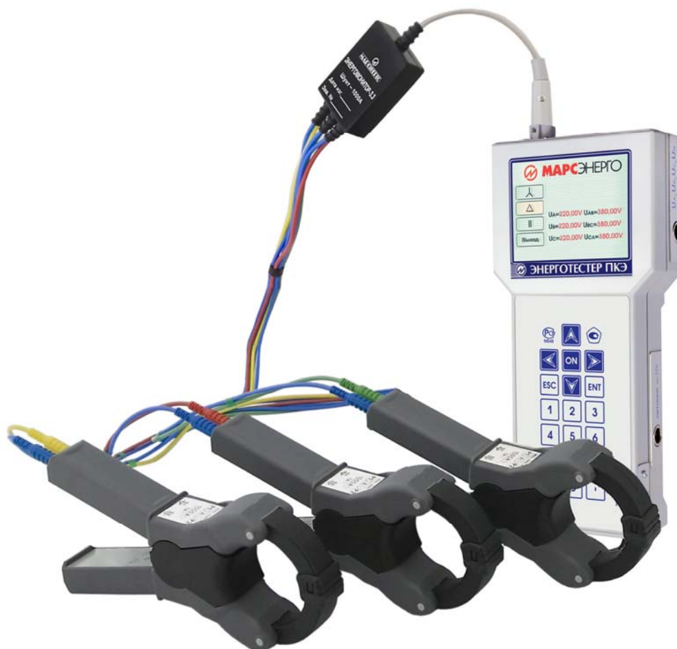
Рисунок А8 Схемы подключения токоизмерительных клещей 1000А к Энерготестеру ПКЭ через Шунт 100А.
