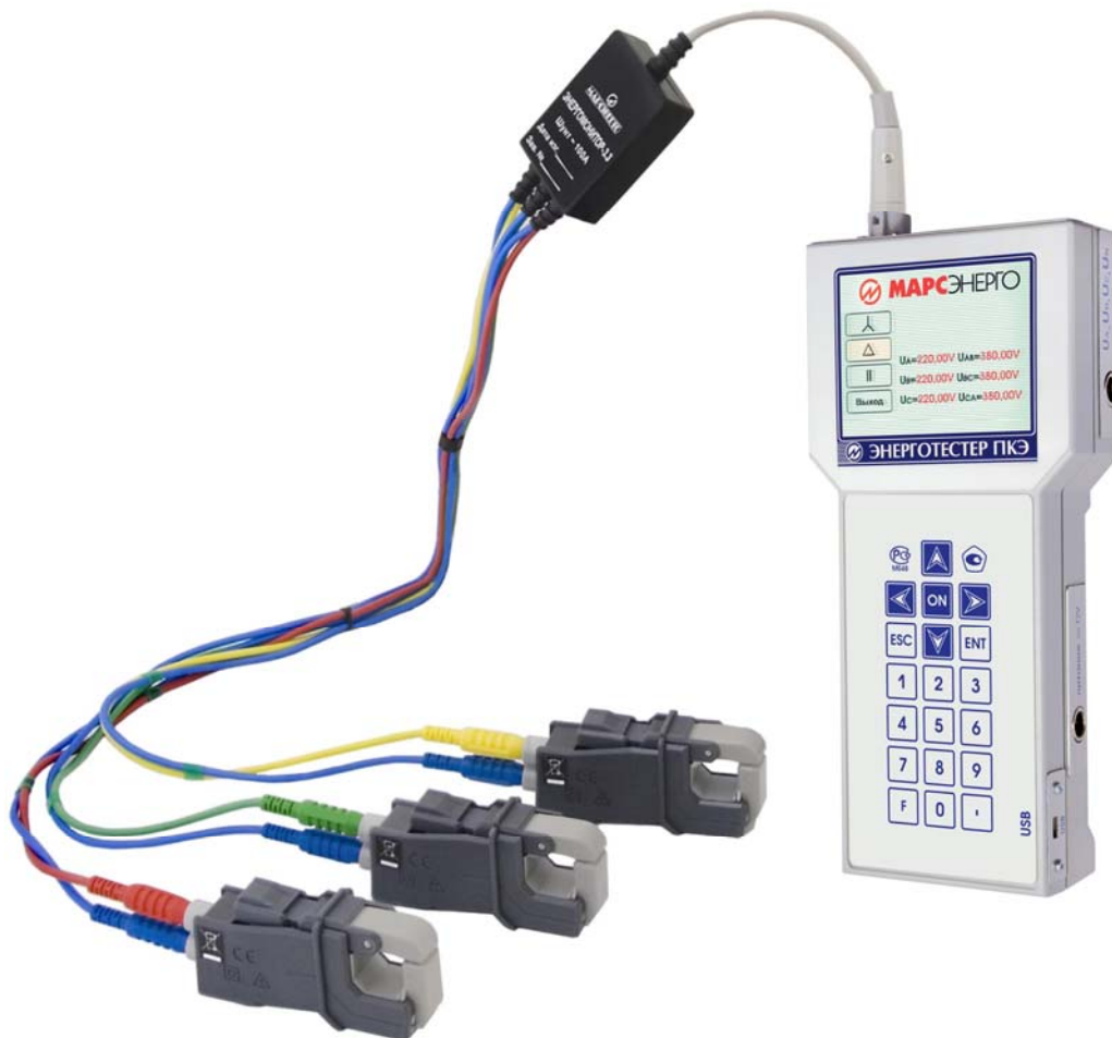
Рисунок А4 Схемы подключения токоизмерительных клещей 100А к Энерготестеру ПКЭ через Шунт 100А.
