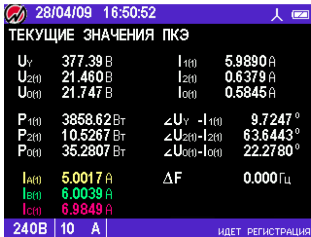
Рисунок 4.3.6 Окно отображения установившегося отклонения напряжения, коэффициентов несимметрии напряжения и отклонения частоты для различных схем включения
