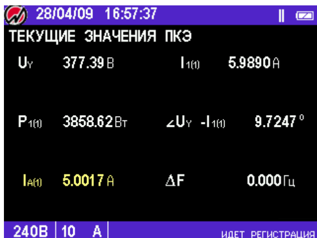
Рисунок 4.3.7 Окно отображения токов и мощностей прямой, обратной и нулевой последовательности для различных схем включения
