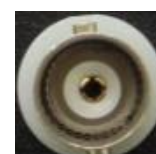
Разъемы X, Y, Z, П, А (BNC)
