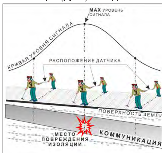
применение датчика-определителя дефектов коммуникации (ДОДК) методом max
