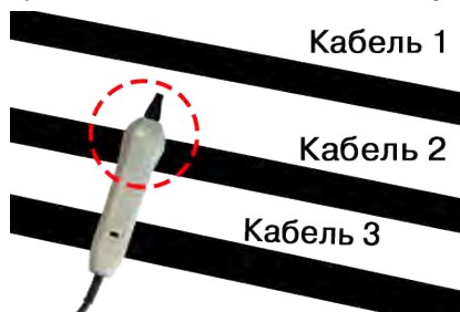
Выбор кабеля по максимальному сигналу
