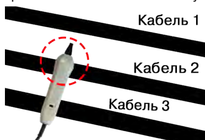
Выбор кабеля по максимальному сигналу
