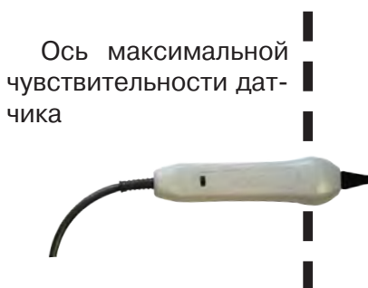
Выбор кабеля по максимальному сигналу
