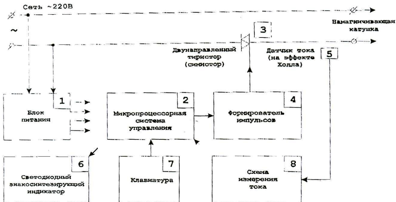
Рисунок 4.4 Электрическая блок-схема модуля МД-С.
