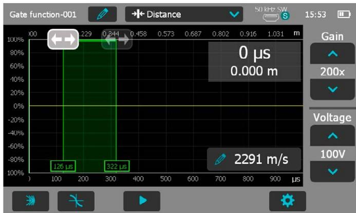
Чтобы найти подходящий диапазон, рекомендуется сначала выполнить автоматическое определение скорости импульса, а потом выполнить быстрый В-скан для определения диапазона для донного сигнала.
