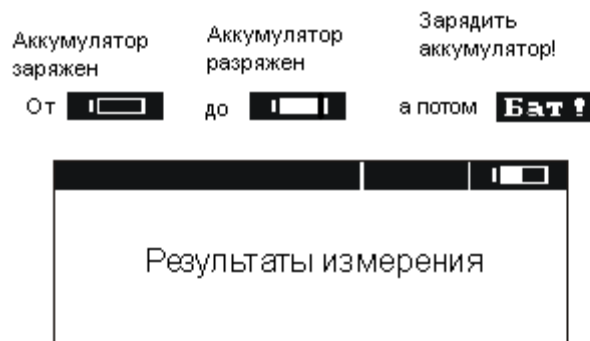
Контроль состояния зарядки аккумуляторов
