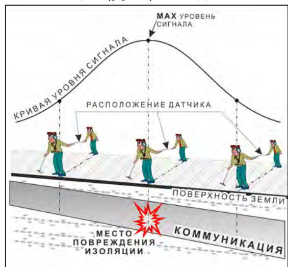
применение датчика-определителя дефектов коммуникации (ДОДК) методом max
