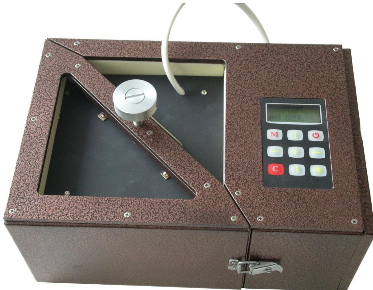
Рис.1 Внешний вид измерителя теплопроводности
