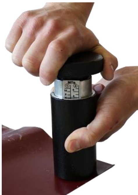
Рисунок 2.6 – Взвод пружины поворотного механизма
