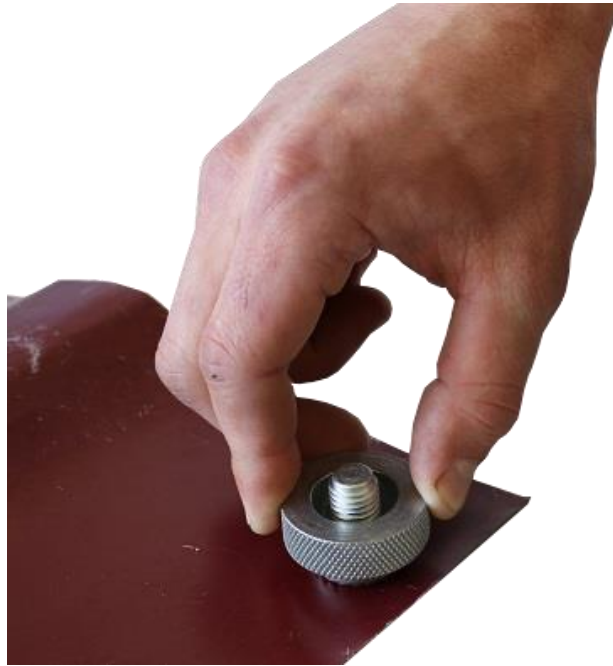
Рисунок 2.3 – Вырезание участка испытания
