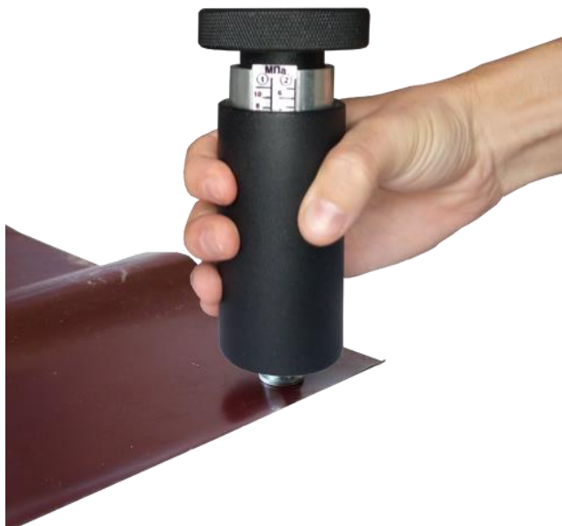
Рисунок 2.5 – Процесс наворачивания механизма на грибок
