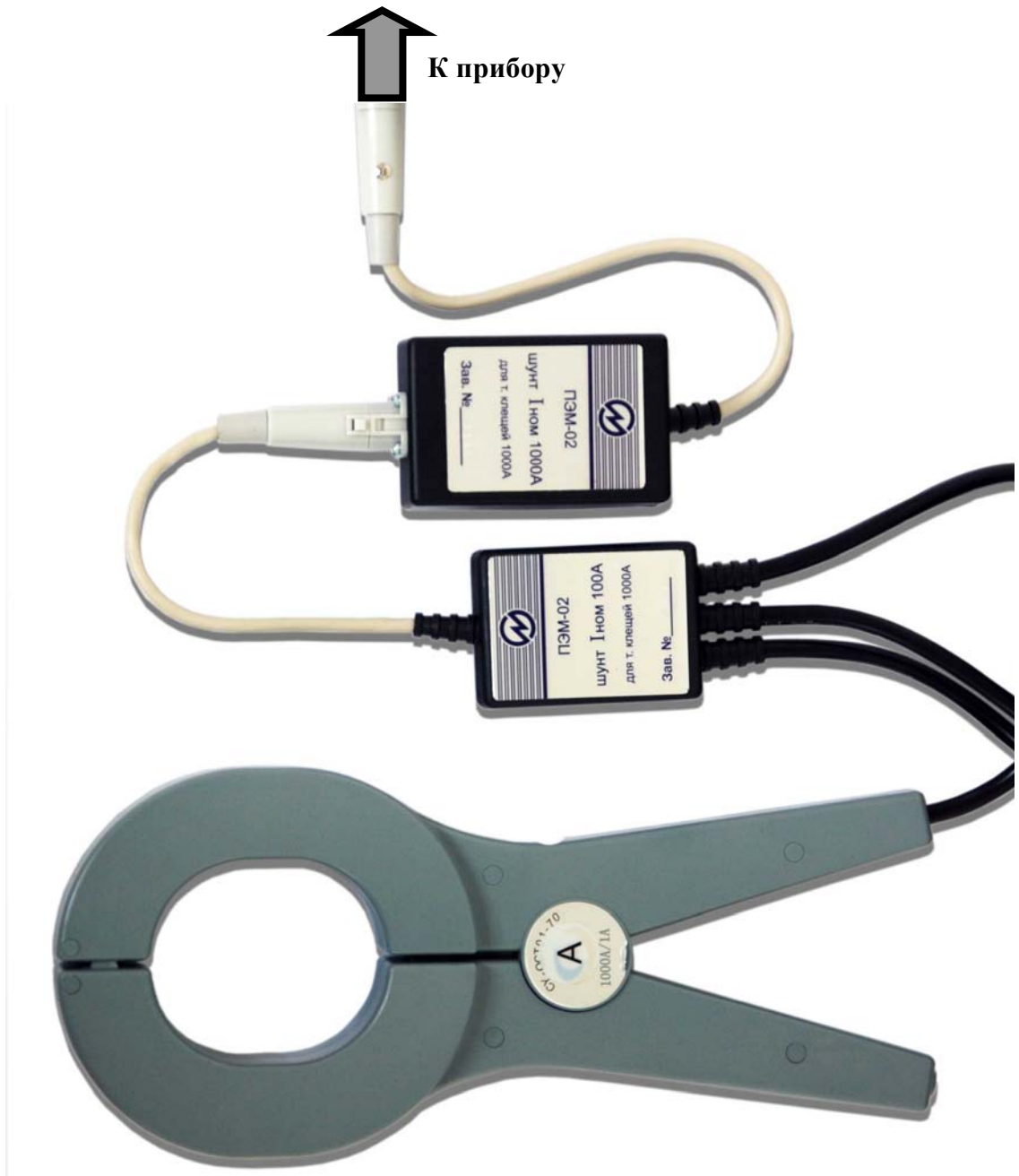
Рис. А.7. Схема подключения токоизмерительных клещей 1000 А к Прибору ПЭМ-02 через шунты I_H = 100 А и I_H = 1000 А для измерений на пределе 1000 А
