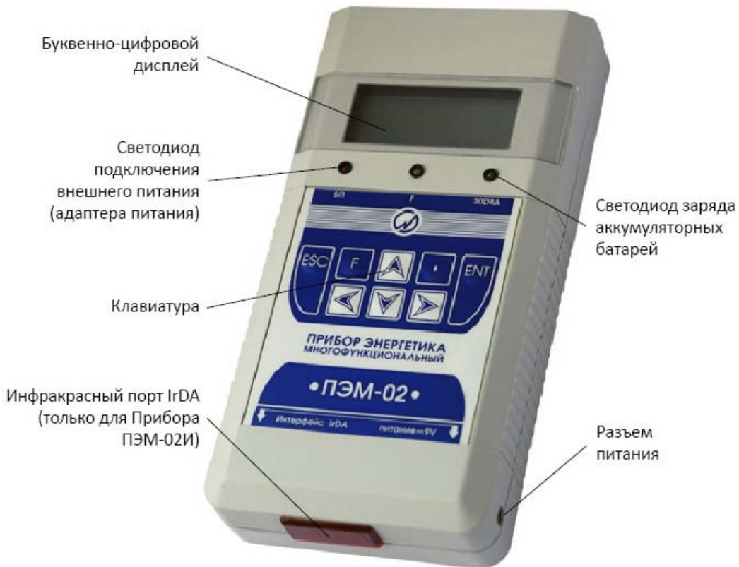
Рис. 3.1. Передняя панель Прибора ПЭМ-02
